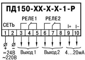
Рисунок 5 – Назначение контактов
