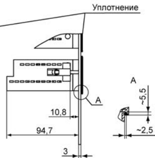
Рисунок А.6 - Прибор в корпусе Щ2, установленный в щит толщиной 3 мм
