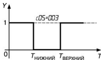
Рис. 3.17. Компаратор срабатывает вне установленных пределов
