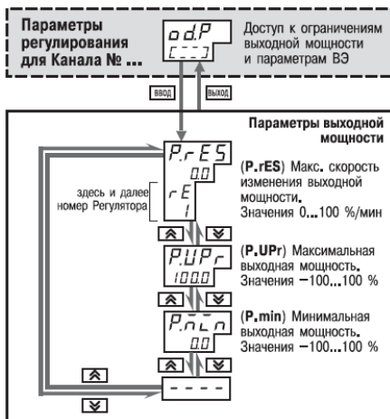
Рисунок 11.10 – Схема задания основных параметров конфигурации (продолжение). Задание ограничений выходной мощности
