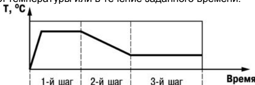
Рисунок 3.2 – Пример Программы технолога для ТРМ151-03
