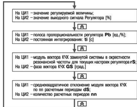
Рисунок 12.3 – Схема переключения индикации в режиме Автонастройки
