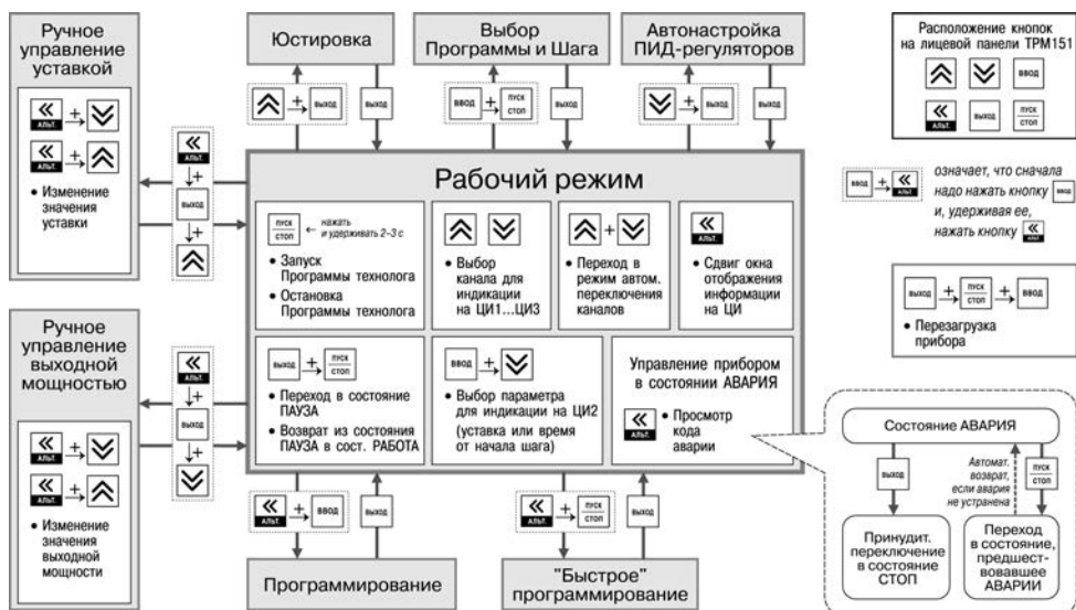
Рисунок 5.3 – Схема переключения режимов прибора
