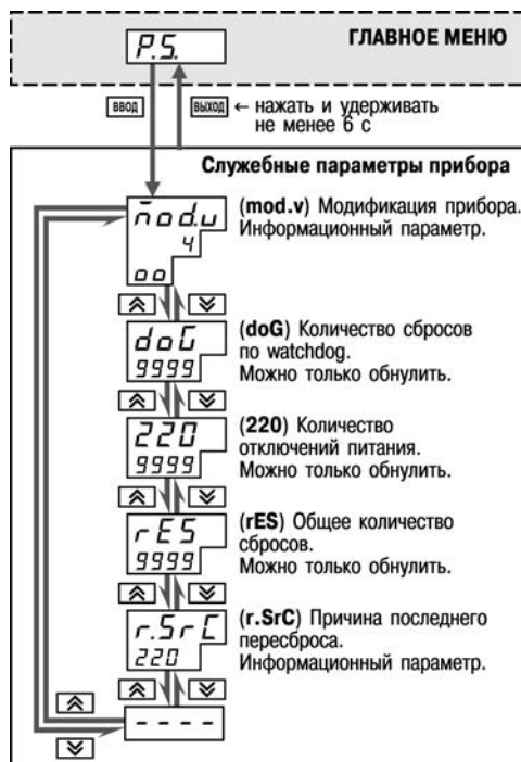
Рисунок 11.18 – Схема доступа к служебным параметрам прибора
