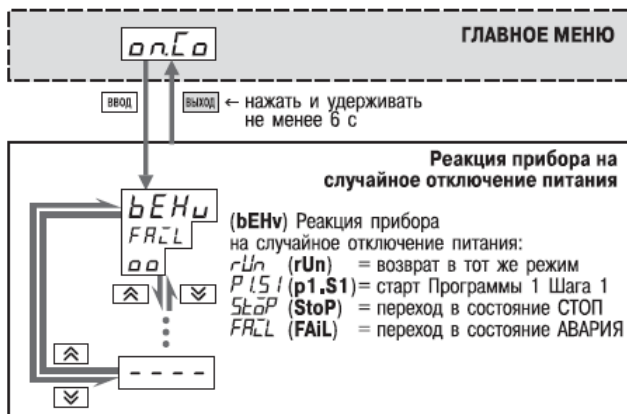
Рисунок 11.20 - Схема задания реакции на случайное отключение напряжения питания
