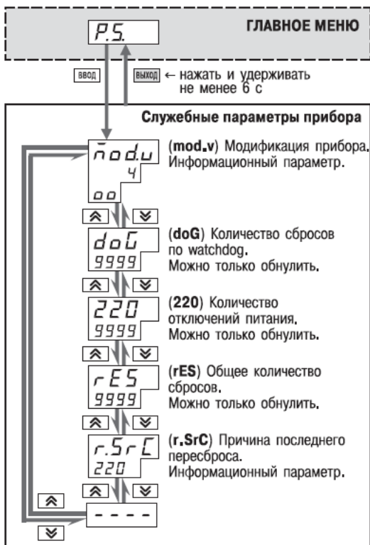
Рисунок 11.21 - Схема доступа к служебным параметрам прибора
