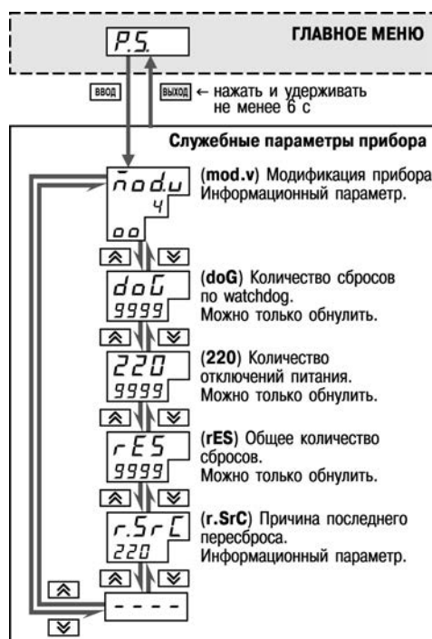
Рисунок 11.18 – Схема доступа к служебным параметрам прибора
