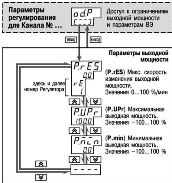
Рисунок 11.13 – Схема задания основных параметров конфигурации (продолжение). Задание ограничений выходной мощности
