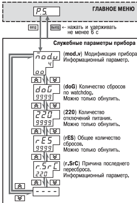
Рисунок 11.16 – Схема доступа к служебным параметрам прибора
