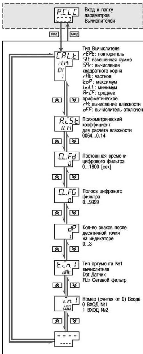
Рисунок 11.11 – Схема задания параметров Вычислителей
