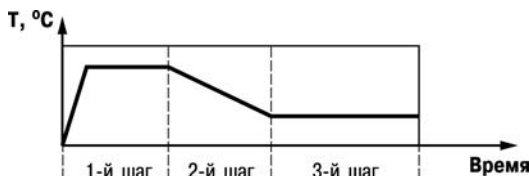
Рисунок 3.2 – Пример Программы технолога для TRM151-10
