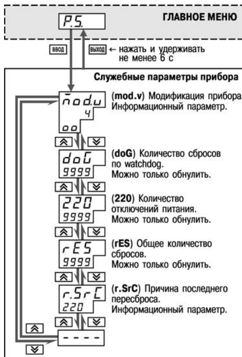
Рисунок 11.19 – Схема доступа к служебным параметрам прибора
