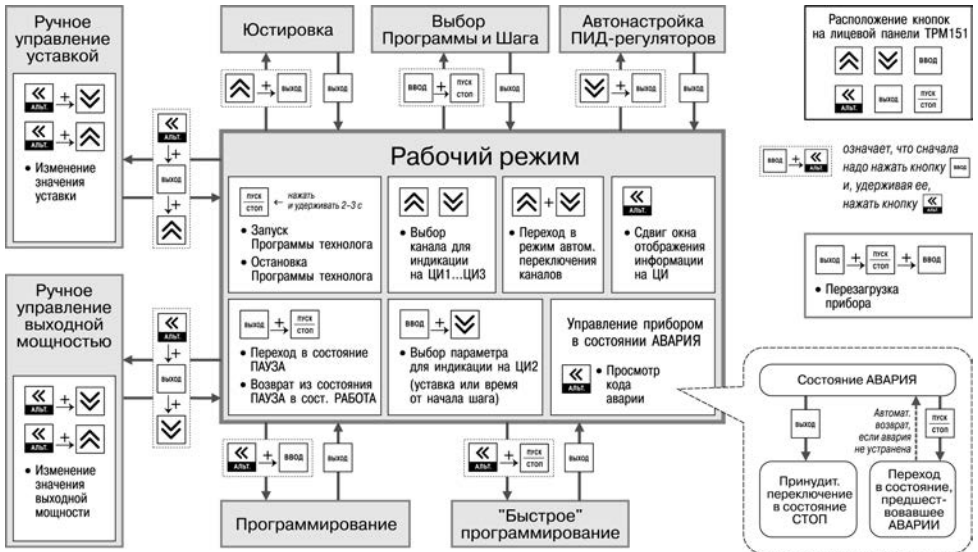
Рисунок 5.3 – Схема переключения режимов прибора
