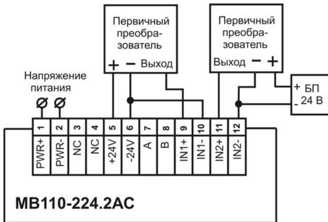
Рисунок Б.3 – Подключение к прибору трехпроводных первичных преобразователей
