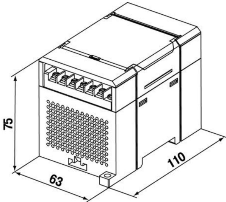
Рисунок А.1 – Габаритный чертеж МУ110
