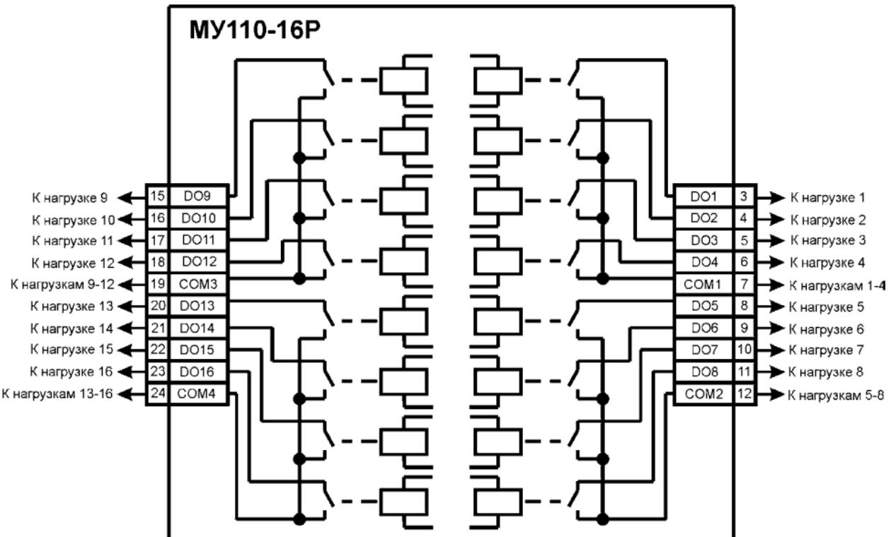
Рисунок Б.2 – Схема подключения к ВЭ типа электромагнитное реле
