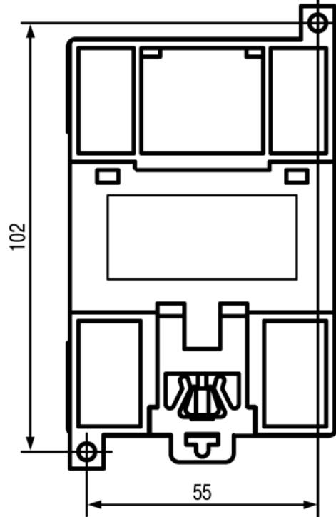
Рисунок А.2 – Установочный чертеж МУ110
