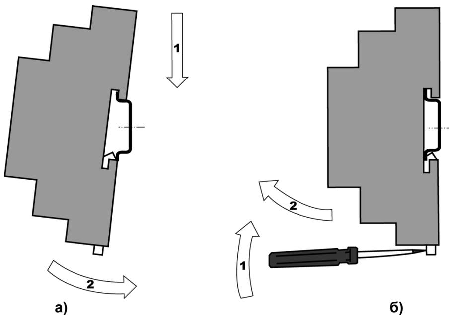
Рисунок 5.1 – Монтаж прибора с креплением на DIN-рейку
