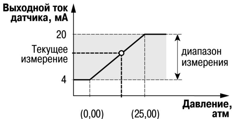
Рисунок 6.4 - Пример задания диапазона измерения
