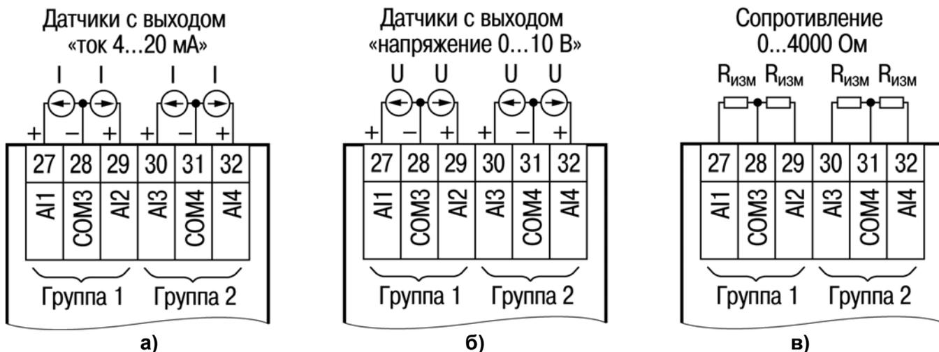
Рисунок 5.10 – Схема подключения к аналоговым входам:
