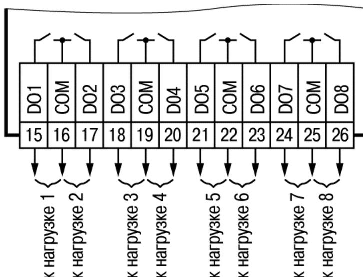
**Рисунок 5.4 - Схема подключения нагрузки к ВЭ типа Р**
