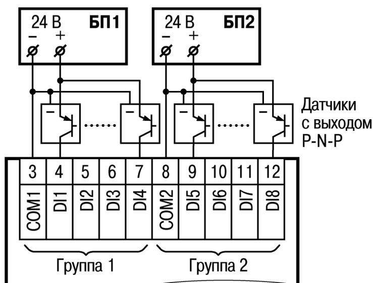
Рисунок 5.9 – Схема подключения к ПР200 трехпроводных дискретных датчиков, имеющих выходной транзистор *p-n-p*-типа с открытым коллектором
