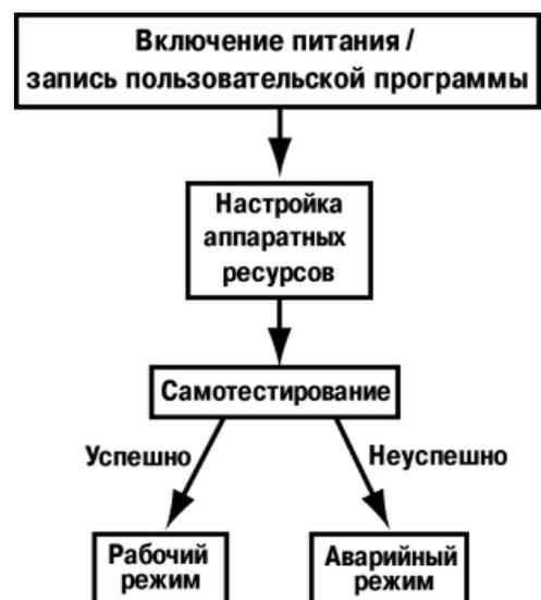
Рисунок 4.2 – Алгоритм запуска прибора
