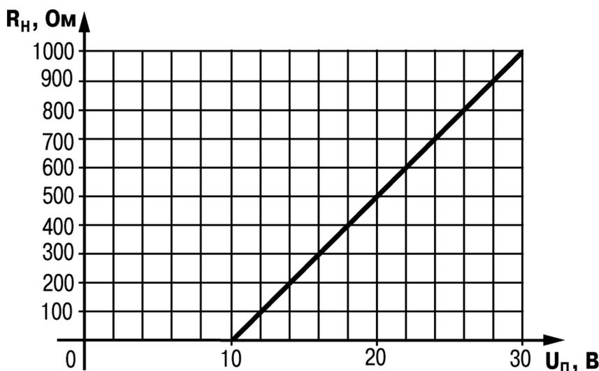
Рисунок 5.6 - График зависимости  $R_n$  ( $U_n$ )
