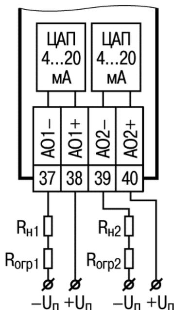
**Рисунок 5.5 - Схема подключения нагрузки к ВЭ типа И**
