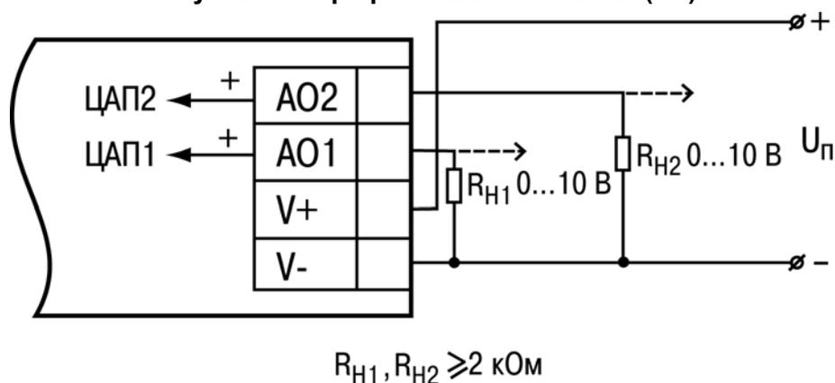
Рисунок 5.7 - Схема подключения нагрузки к ВЭ типа У
