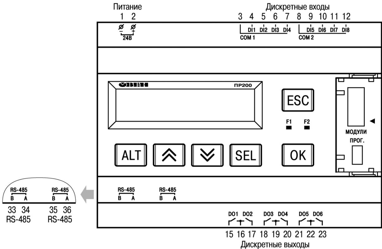
Рисунок Б.3 – Расположение контактов и элементов индикации в приборе ПР200-24.1.X
