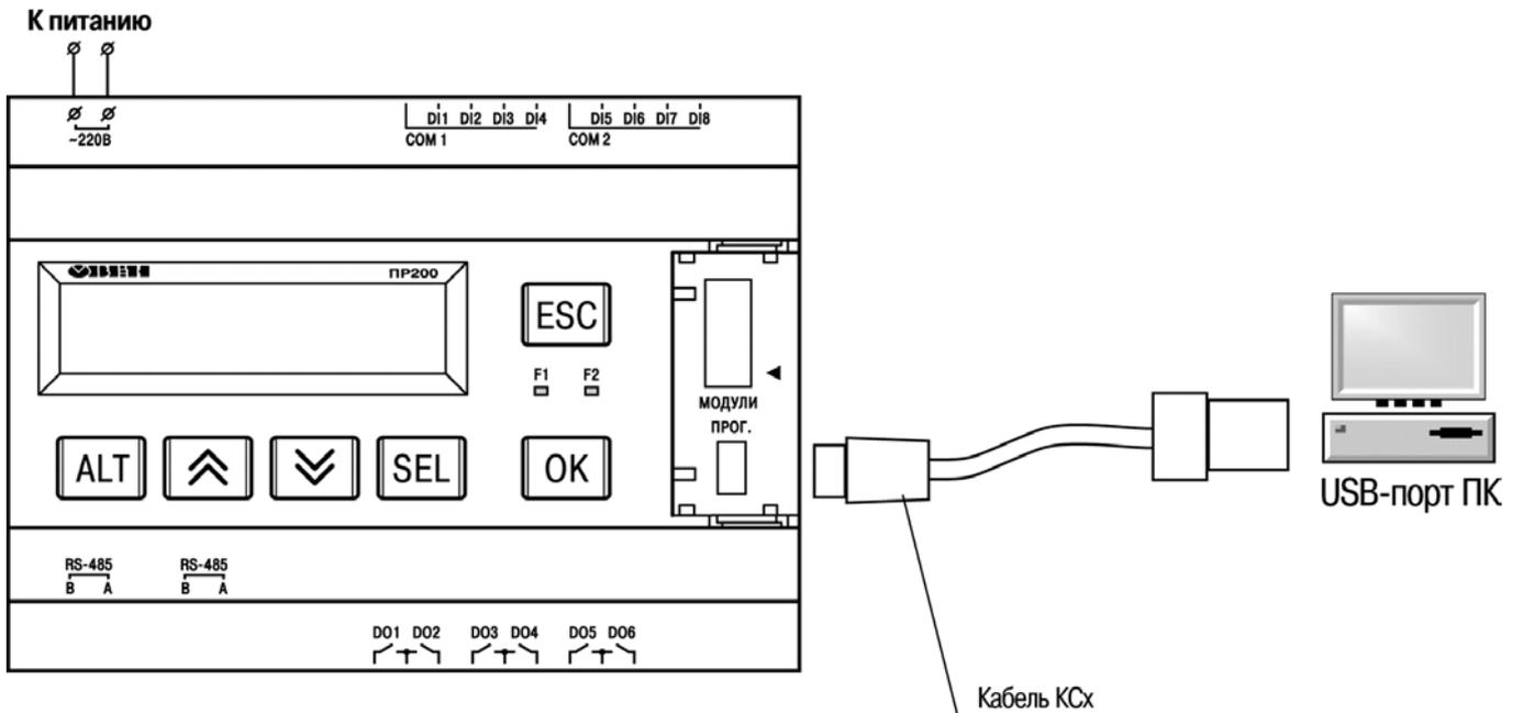
Рисунок Б.10 – Схема подключения ПР200 к ПК
