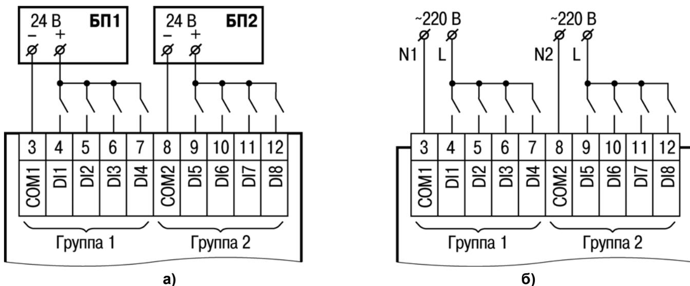
Рисунок 5.8 – Подключение к ПР200 дискретных датчиков с выходом типа «сухой контакт»: а) к ПР200.24; б) ПР200.220
