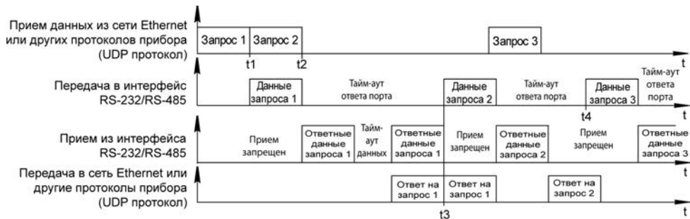
Рисунок 4.7 – Диаграмма работы прибора в режиме «запрос – ответ»
