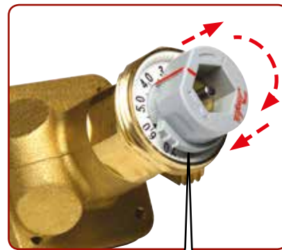
Поднять серое пластиковое кольцо, поворачивая его, выставить требуемую проектную настройку
